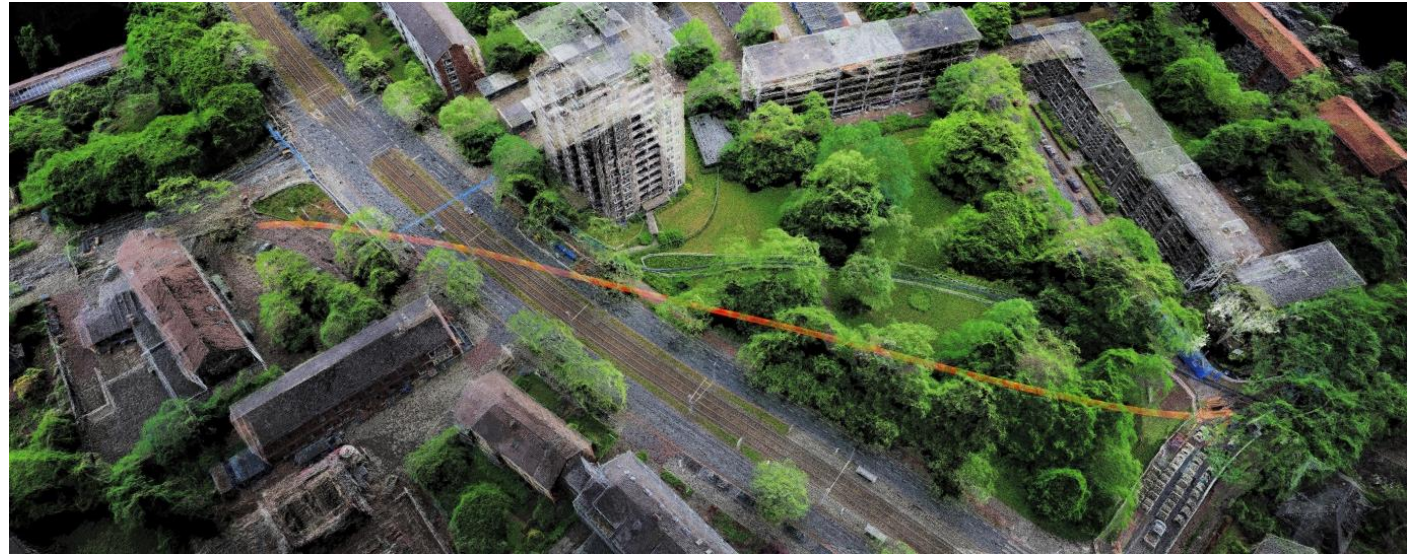
Abb. 1: Ansicht der verknüpften Punktwolken aus terrestrischem 3D Laserscanning mit Drohnenbefliegung (UAV)
