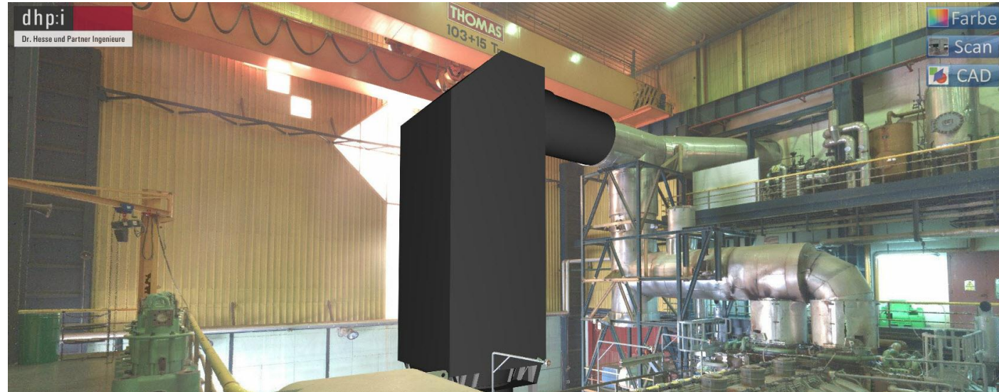
Abb. 1: Laserscan-Viewer mit geplantem CAD Modell
